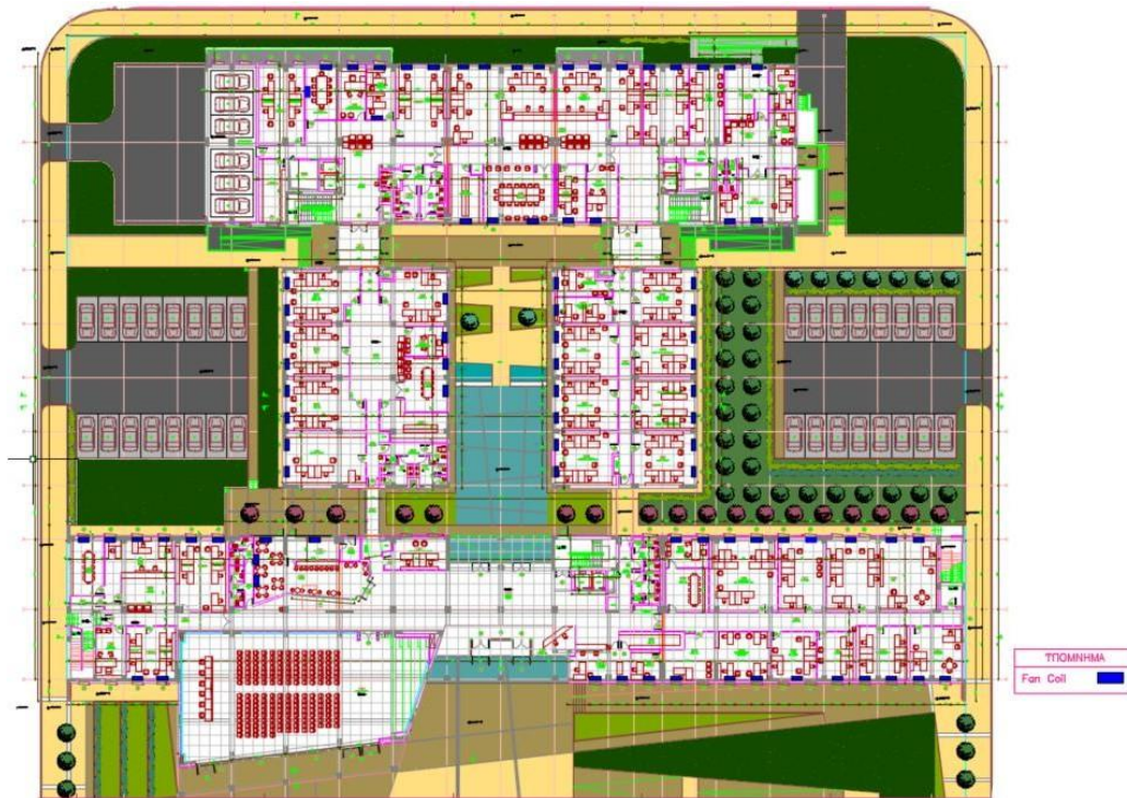
Εικόνα 70 Fan coil ισογείου
