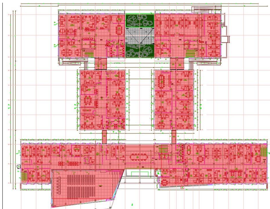
Εικόνα 52 Θερμαινόμενοι χώροι (όροφος)
